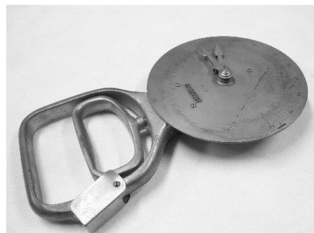
図 2 法政大学が保有する安藤研究所製のスメドレー式握力計
