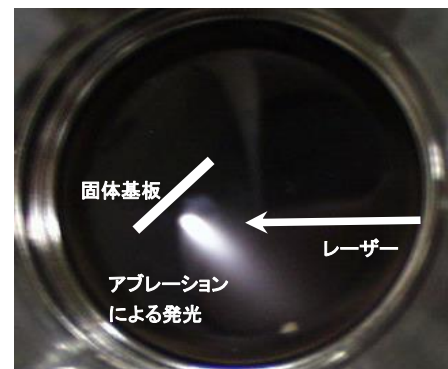
図1 パルスレーザーで固体表面を照射した際にみられる発光
