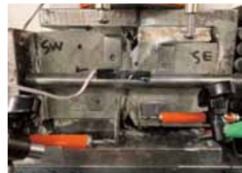
Hager 型 1 面せん断試験実施状況
