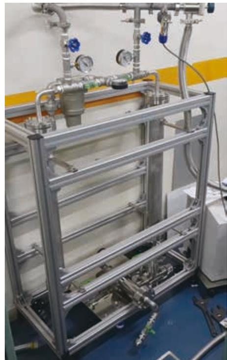
図2 絶縁ガス乾燥装置の全体写真
