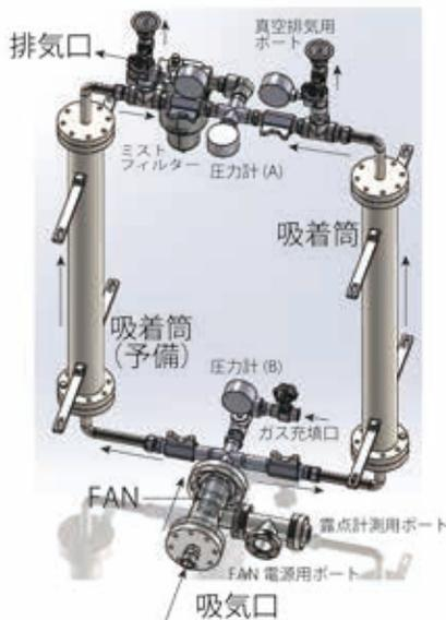
図1 絶縁ガス乾燥装置の全体図
