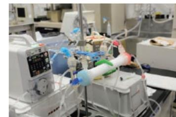
透析治療に用いられる人工臓器。プラスチック製の外筒の中に1万本の中空系が詰められていて、中に血液を通すことで血液を浄化できる
