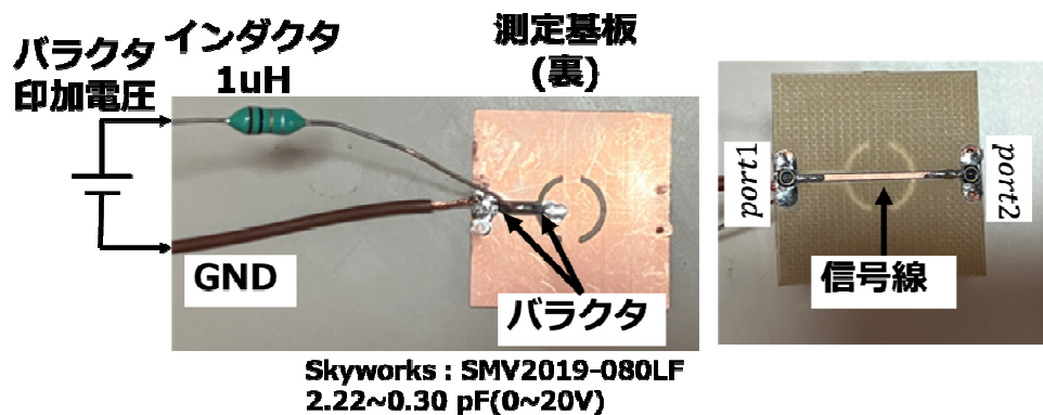
実験に用いたプリント基板（バラクタによるディップ周波数可変）
