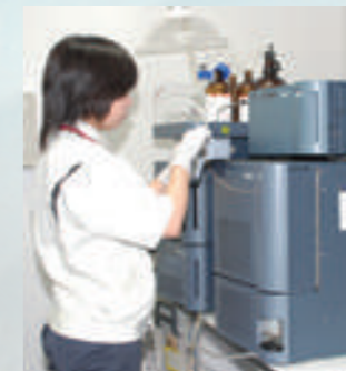
液体クロマトグラフ質量分析計 Liquid chromatography mass spectrometer 液体クロマトグラフィーにより分離された、有機物質等をイオン化し、質量分離して検出する装置です。主に農業、有機汚染物質などの測定に使用されています。
