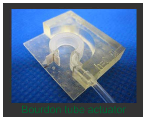
図 9 試作したブルドン管形アクチュエータ
