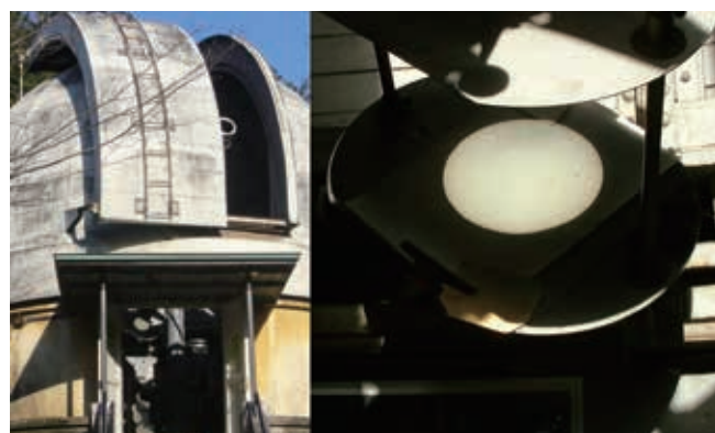
左：第一赤道儀室と20cm望遠鏡 右：スケッチ用紙に映し出された太陽像
