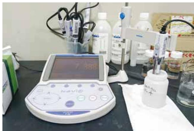
電極を用いた湧水のpHの測定
