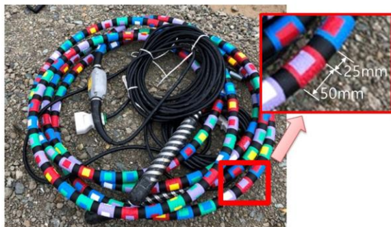
図-3 バイブレーターホースのカラーリング
