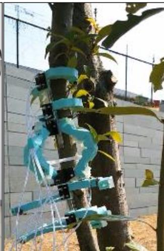
図3シリコン製小型ソフトロボット
