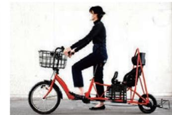
安全性を高めた子ども乗せ自転車の研究事例。乗車位置を低くした子ども座席を鉄パイプのフレームで覆うことで、もし転倒しても子どもへの衝撃を軽減できる
