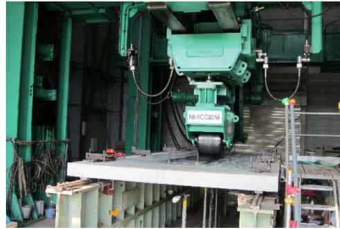
写真11 RC床版打換え後の輪荷重走行試験
