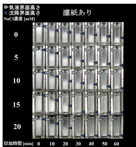
図3 電場印加による沈降促進実験結果 (左) 膜なし (右) 膜あり
