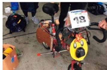
1年次に手掛ける電気自転車、市販自転車を分解し、モーターなどを積み込んで組み立て直す形で改造。写真は2019年に製作した1台
