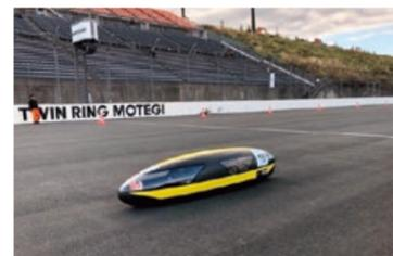
現在改造中のエコカー車両は、電池のみのパワーでツインリンクもてぎの1周2.4kmコースを走行できるように空気抵抗を抑えた流線形
