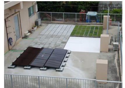
屋上緑化・空気層を利用した置き屋根の温熱環境実験、沖縄糸満市
