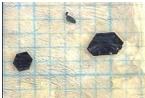
図1 作成した有機無機ハイブリッド型ハロゲン化鉛ペロブスカイト単結晶薄膜
