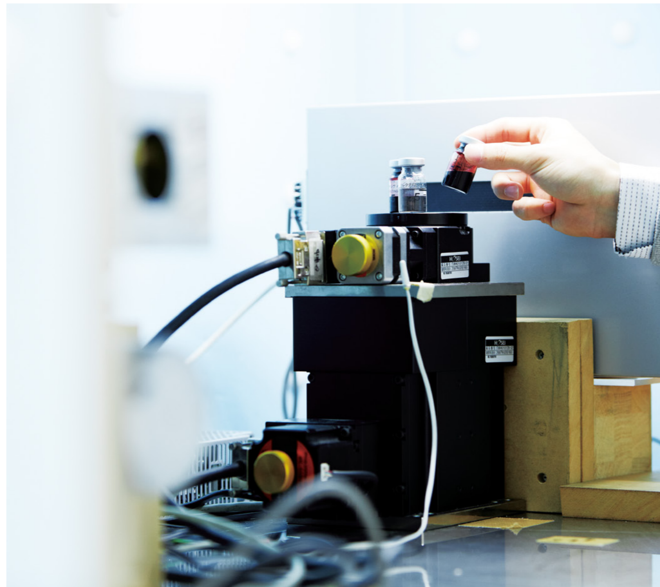
画像工学研究室(尾川浩一教授)では、X線とコンピュータを用いて、体内や物体の内部構造や機能を視覚化する研究を行っている。写真の機器は、対象物の光子(光子)の数を計測できる「フォトンカウンティングCT」
