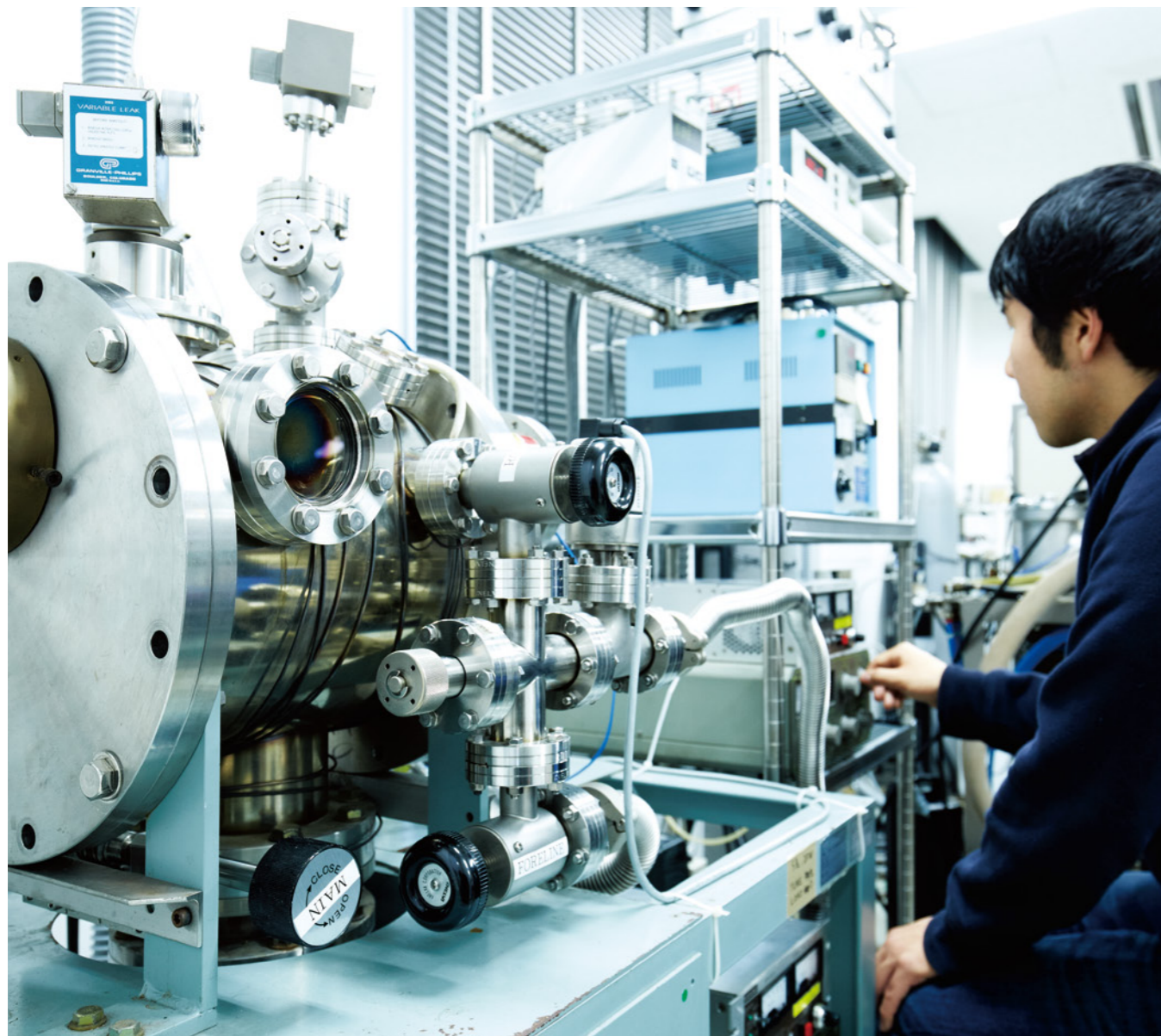
電子材料工学研究室(山本康博教授)では、次世代の高速電子デバイスを実現するための半導体および誘電体材料の研究を行っている。写真の機器は、半導体などに利用される薄膜を生成する「スパッタリング装置」
