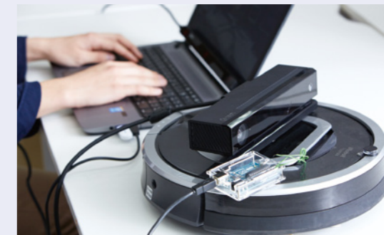
脳情報処理研究室(平原誠准教授)。目の動きをセンサーが読み取り、それによってロボット掃除機を動かすシステムを学生が開発。
