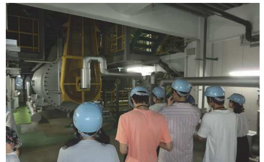
株式会社アルフォ：タンクの中で食品廃棄物の水分が除去されて、家畜の飼料になります。
