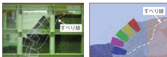
● 残留変形図（実験結果（左）と解析結果（右）
